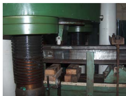
Încercare la încovoiere pe tronson de cale ferată, sudat pe întreaga secțiune transversală, cu măsurarea deformațiilor în mijlocul deschiderii (axa sudurilor).
