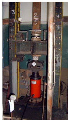
Încercare la compresiune centrică a unei bare cu secțiune chesonată pentru determinarea forței critice de flambaj
